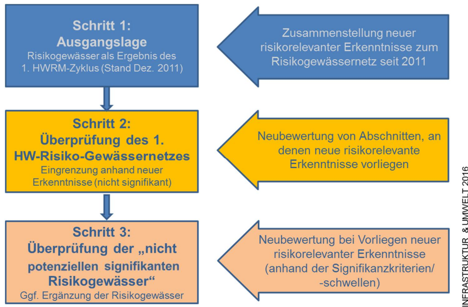
Abbildung 2: Arbeitsschritte der vorläufigen Bewertung im 2. Zyklus zur Überprüfung der Gewässer mit potenziellem signifikantem Hochwasserrisiko
